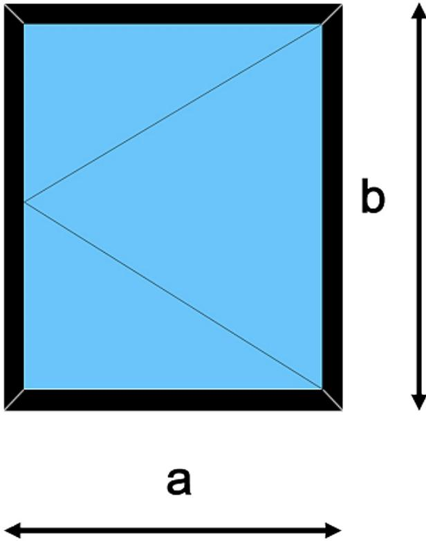
Für die Richtigkeit und normativ korrekte Rundung der Eingabewerte  $U_f$ ,  $U_g$  und  $\Psi_{si}$  ist der Anwender verantwortlich. Die Berechnungsnorm EN ISO 10077-1 fordert eine Rundung der  $U_f$ - und  $\Psi_{si}$ -Werte auf zwei Nachkommastellen und eine Rundung der  $U_g$ -Werte auf eine Nachkommastelle.
